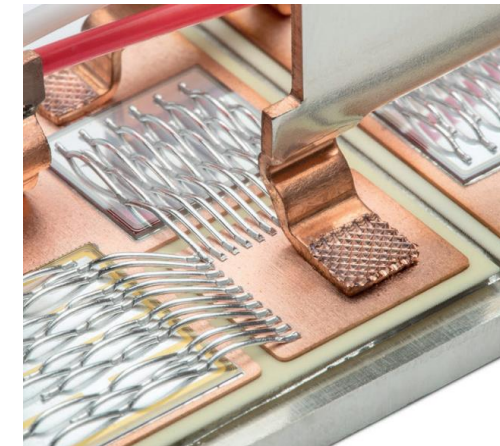
«Лапка» токового вывода приваренная ультразвуковой сваркой
