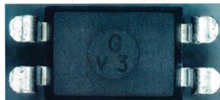
Оптопары не соответствуют заявленному варианту формовки выводов. Представленные оптопары соответствуют варианту № 9 (рис. 4). Типовой вид оптопары сбоку приведен на рисунке 4.
