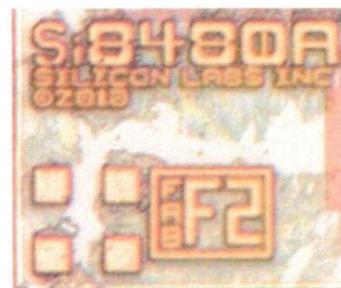
Рисунок 10 – Укрупненная маркировка кристалла
