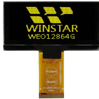
Zif FPC (с ребром жесткости)
