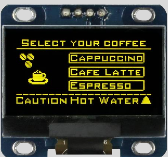
COG + PCB (встроенной схемой электрического питания)
