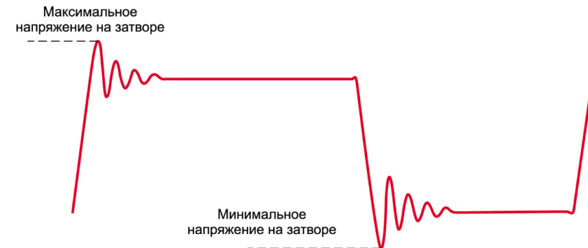
Амплитуда напряжения на затворе SiC MOSFET
