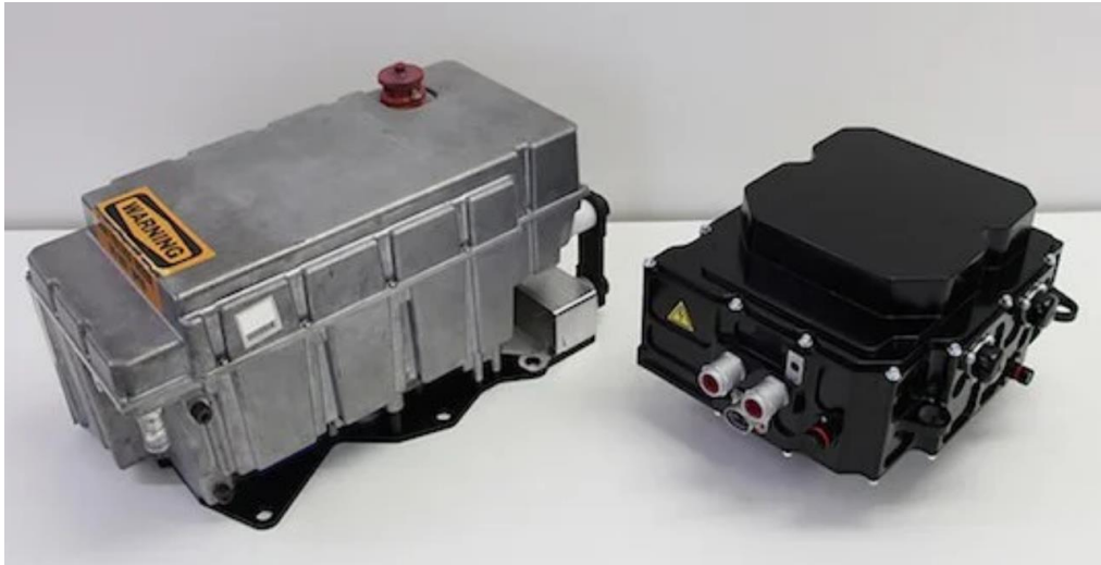
Инвертор на основе Si IGBT ( слева ) мощностью 200 кВт, частота переключения 10 -15 кГц и инвертор на основе SiC MOSFET ( справа ) мощностью 220 кВт частота переключения 75 -100 кГц
