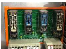
UCMP контрольная панель (OMRON G7SA)
